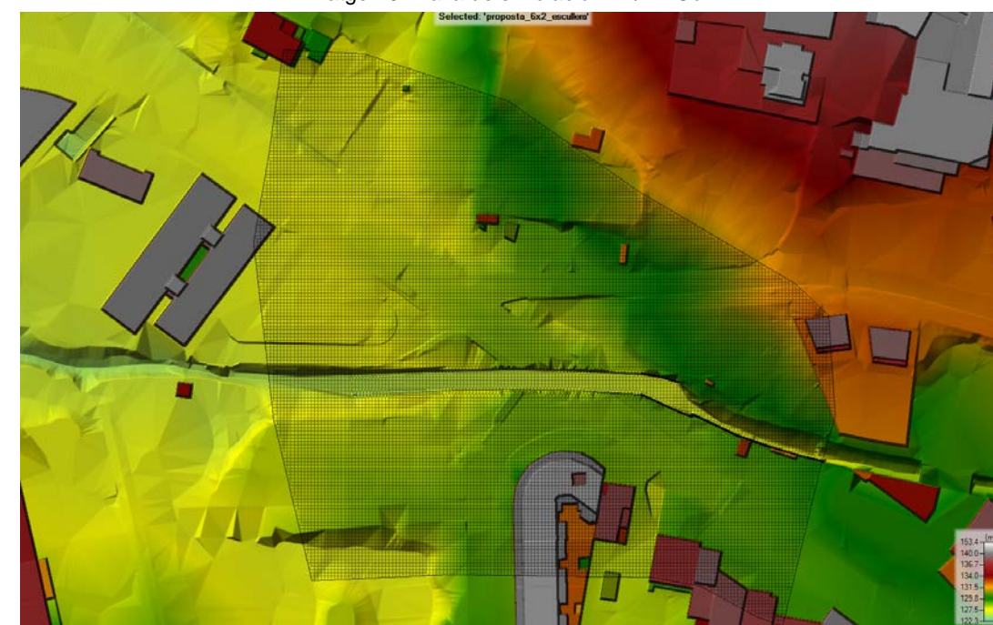
Imatge 16. Malla de simulació i 2A/2D Conn.
